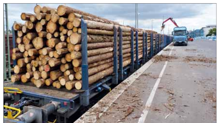
Die Lkw-Fahrer beladen per Ladekran direkt den bereitstehenden Ganzzug, bestehend aus 23 Rungenwagen der Gattung SNPS.
