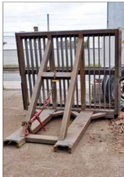
Mit einem auf die Gabelzinken aufgesetzten Gitter schiebt ein Teleskopklader das Holz bündig in den Container auf einem Lkw, der den Transport innerhalb des Hafengeländes übernimmt. Fotos: Hunkemöller (links), Stephan Kirchner (rechts, oben)
