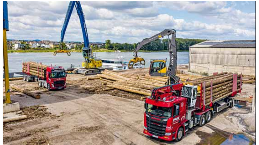
Im Rheinhafen Bendorf werden Break-Bulk-Schiffe mit dem Umschlagbagger beladen. Fotos: Pfau (2) Pfau nutzt bis zu zwölf LKW, die täglich etwa 50 Fuhren aus dem Wald zum Hafengelände bringen.
