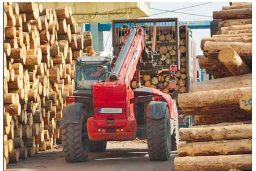
Mit einem auf die Gabelzinken aufgesetzten Gitter schiebt ein Teleskopklader das Holz bündig in den Container auf einem Lkw, der den Transport innerhalb des Hafengeländes übernimmt. Fotos: Hunkemöller (links), Stephan Kirchner (rechts, oben)
